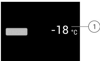
Fig. 6 Індикатор стану показує фактичну температуру.
