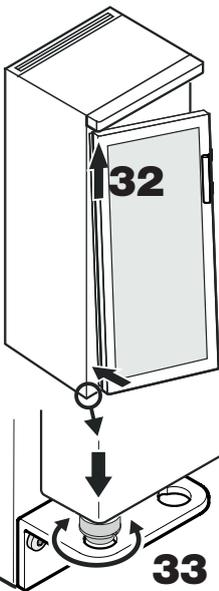
**33.** Приподнимите дверь и поверните штифт, чтобы он вошел в отверстие шарнирного уголка.
