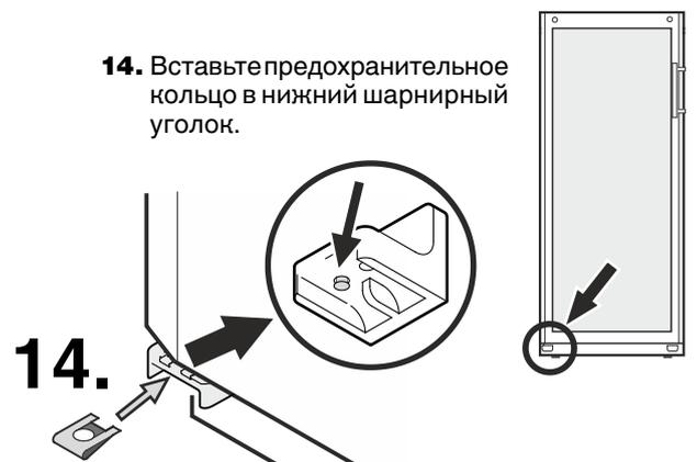
**14.** Вставьте предохранительное кольцо в нижний шарнирный уголок.
