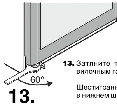
**13.** Затяните торсион прилагающимся вилочным гаечным ключом:  $> 60^\circ$ .
