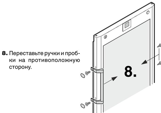
**8.** Переставьте ручки и пробки на противоположную сторону.
